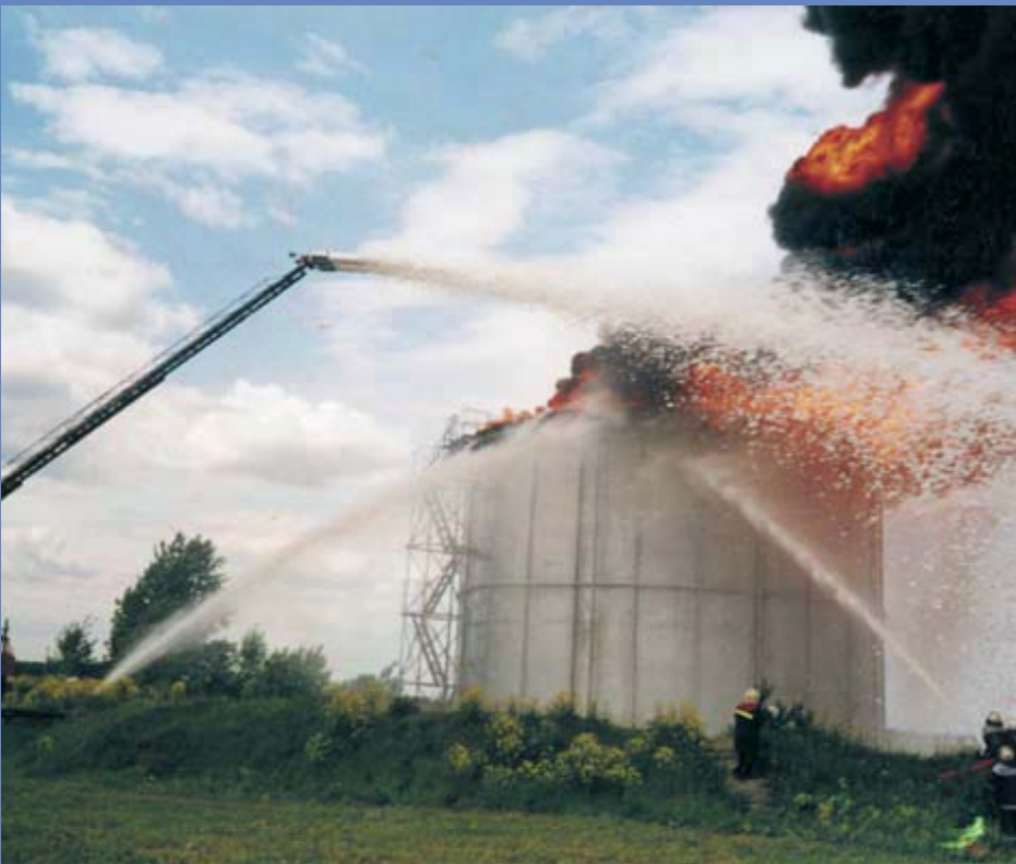
Установка комбинированного тушения пожаров «Пурга» в действии
